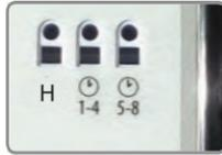
Si utiliser des thermostats esclaves avec les lignes NSB connectées, un contact sec d'horloge externe peut contrôler la fonction NSB des thermostats esclaves.
