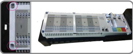
Desserrer les deux vis sur la gauche de la plaque à borne blanche, puis soulever à retirer pour l'accès aux bornes du cordon d'alimentation. **A**
