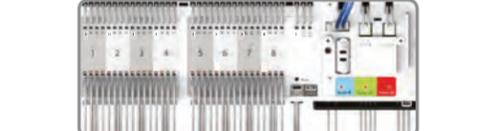
**Remarque :** Pour les fonctions de groupe, veillez à connecter la ligne de commande NSB des thermostats maître et esclave. Pour un fonctionnement autonome du thermostat, NE PAS brancher la conduite de commande NSB du thermostat.
