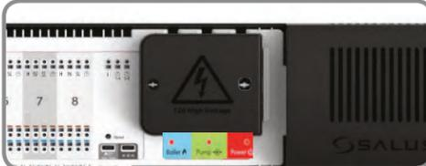
Retirer le couvercle de haute tension en desserrant les vis de fixation.
